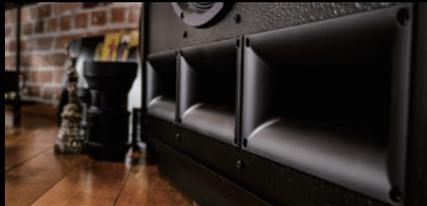
新設計のTractrix®ポートは、最も効率的で最速の空気の流れを可能とし、ポートノイズを低減します。Tractrix®ポートには、ポートに流入する気流の乱れの低減に効果的なフレアが内側に設置されています。空気の乱れの減少に伴いポートノイズが減少することで、よりクリーンで強力な低音を再生することが可能となりました。
