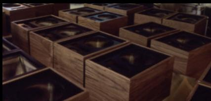
キャビネットの木目が対称になるようにデザインされています。正確な対称性を保持したキャビネットは美しく一貫した仕上がりとなっています。左右ペアで同じ木材から作られた板材を使用しており、各キャビネットを慎重に一致させています。各スピーカーはシリアル番号で管理し、左右の組み合わせに対し細心の注意を払っています。
