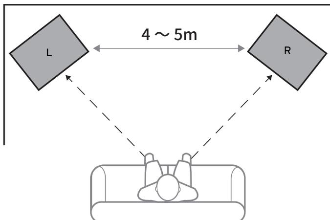
Klipsch La Scala はウーファー部のホーンに、フォールデッドホーン(折り曲げホーン)を搭載しており、必要に応じてコーナーから離れた場所に設置することが可能です。しかし、このモデルは Klipschorn よりも低音の伸びが少ないため、コーナー配置による低域の音響補強が最適です。また、La Scala では、希望するステレオイメージに合わせてトーインの量を自由に設定することができます。また、Klipsch の高性能サブウーファーで重低音性能を高めることも可能です。
